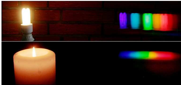
Durch das vor das Auge/Kameraobjektiv gehaltene Gitter sieht man die Spektren in 1.Ordnung in etwa 30° Winkelabstand von der Lichtquelle. Oben: Linienspektrum einer Energiesparlampe; Unten: Kontinuumsspektrum einer Kerzenflamme.
